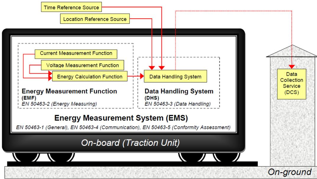
EM4TII 适用于多系统的能量检测，包括 25kV 50/60Hz 和 15kV 16.7Hz，或者 DC 600V，750V，1.5kV 和 3Kv 的供电系统。能量计量可以检测到系统的变化，并存入负荷曲线中。来自变压器和整流器的电压和电流信号可以通过变压器、互感器或传感器接入 EM4TII 的 4 个输入通道，采用 Sigma-Delta 模、数转换器，采样精度高，抑制输入通道的高频干扰，可靠性高。这四个通道可以接收交流或直流信号，实现电压、电流的信号处理。根据用户的不同需求，可以有如下五种选择。
