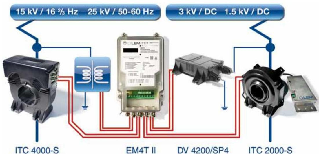
电流测量传感器 ITC 系列，专为能量测量系统设计，用于配套 EM4TII 能量表的电流传感器，采用闭环磁通门技术，零点和增益温漂低，测量电流从 1000A 到 4000A。符合 EN50463 要求，精度 0.5R。
