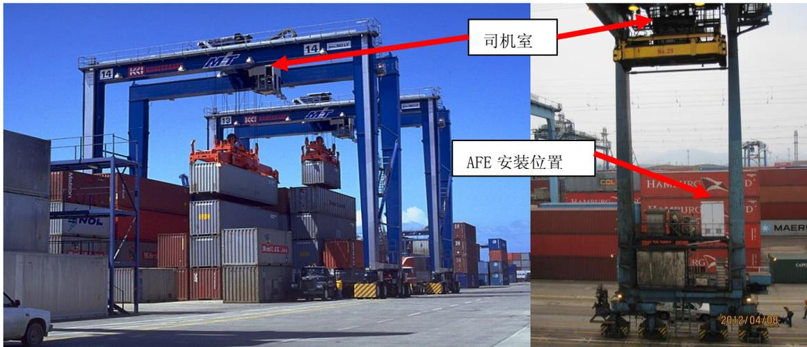
图 2 RTG 工作图和 AFE 安装位置图
