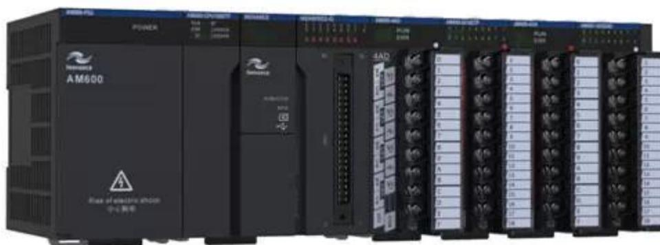
AM600 系列中型 PLC 基于 CoDeSys+A8 的软硬件平台研发而成，完全**支持 PLCOpen 规范的 6 种标准语言编程**；将**EtherCAT 实时总线与运动控制算法相结合**，提供了基于 IEC 运动控制指令，支持多轴电子凸轮/电子齿轮联动、实轴与虚轴可同时相结合控制；控制器网络最多可控制 32 个伺服从站设备。
