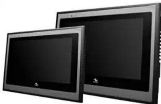
IT6000 系列 HMI 是汇川新一代人机界面系列产品，是在 IT5000 系列 HMI 技术基础上，采用**高性能 32 位 Cortex-A8 处理器**研发的高性能产品。
