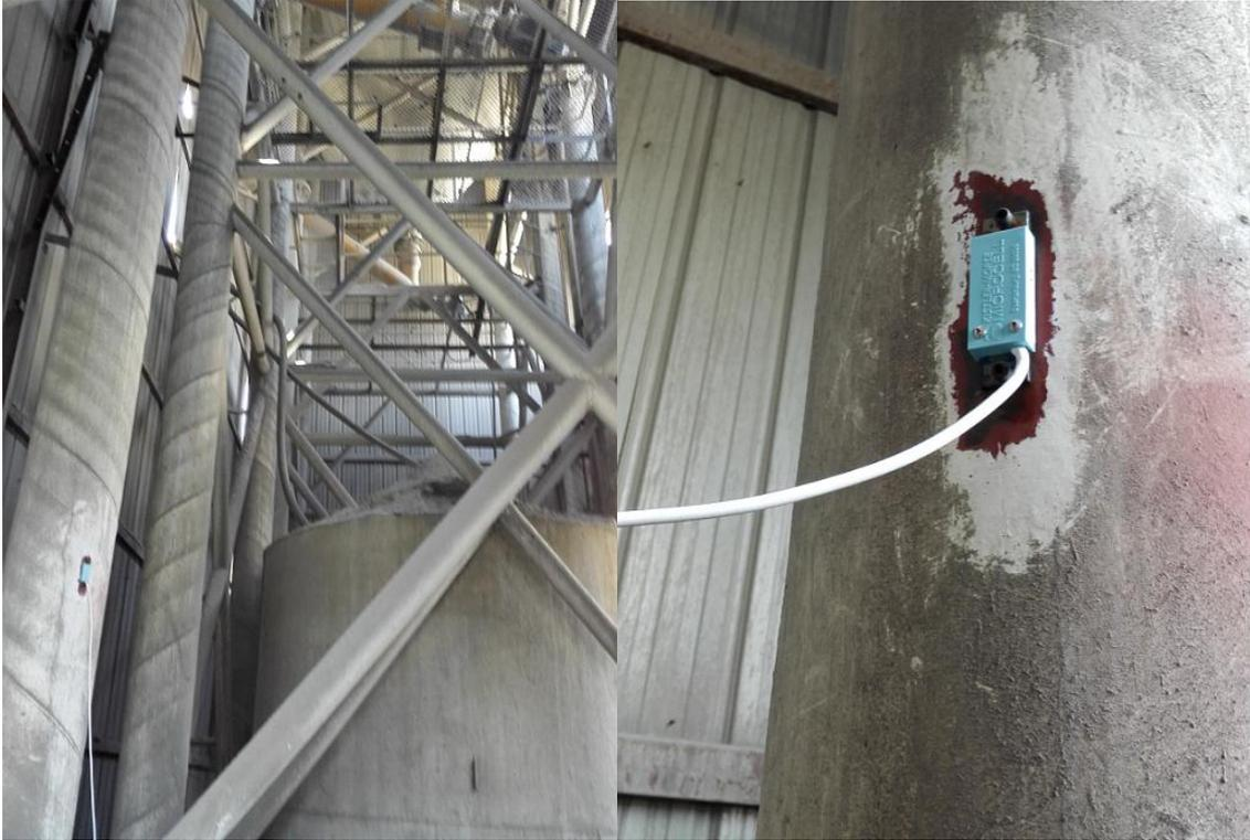
图 5：贴片式传感器现场安装示意
